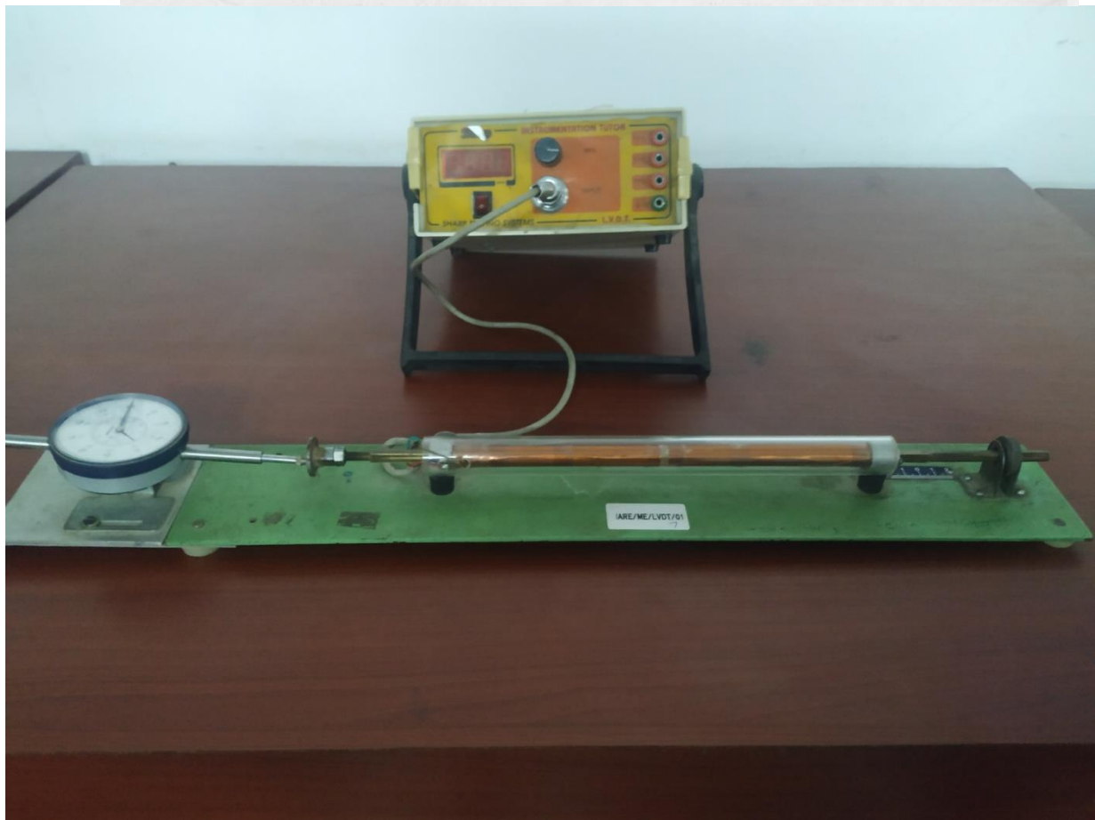
Fig: LVDT setup
