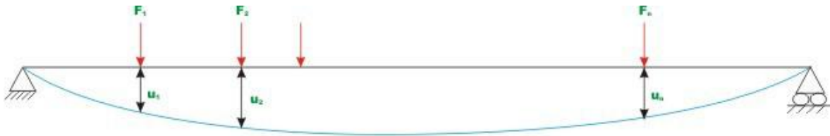
Fig. 5.1a : Actual system of forces.
